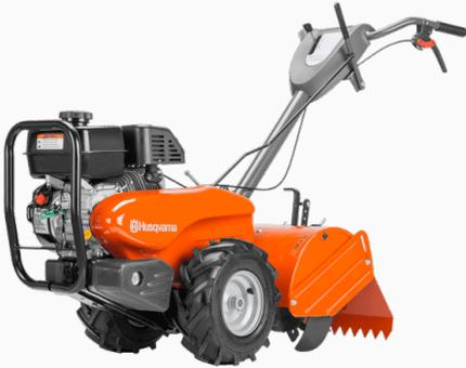
Motocultivador con rotación dual, para arado en ambas direcciones. Versátil para el hogar y para romper terrenos de tierra densa y para cultivo de huertas. Ideal para granjas avícolas, gracias a los dientes de doble rotación, esta máquina realiza tanto la rotación contraria como la rotación hacia el sentido de avance. Accionamiento de cadena tanto en rotores como en ruedas.
